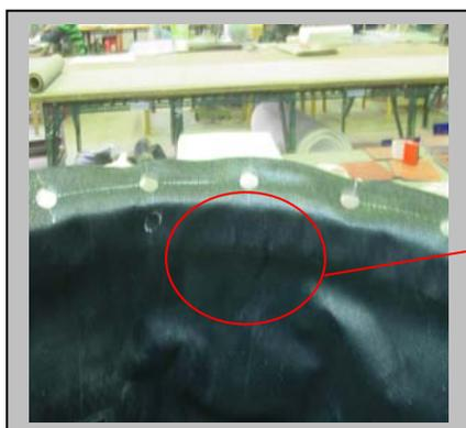
法兰摺边为直撑外翻定型，与接头本体一体成型，无车缝接缝，气密性良好无漏气问题
